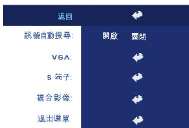
**訊號自動搜尋**—選擇開啓 (預設)，自動偵測可使用的輸入訊號，在投影機開啓時按下**輸入源**按鈕，它會自動搜尋下一個可用的輸入信號；選擇**關閉**，鎖定目前的輸入訊號。當選擇**關閉**並按下**輸入源**時，就可選取想使用的輸入訊號。
